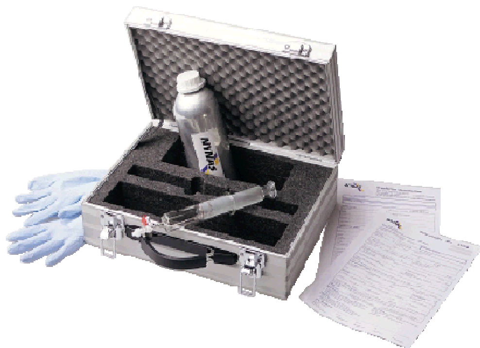
Rys.3. Zestaw Nynas do poboru próbek oleju transformatorowego
